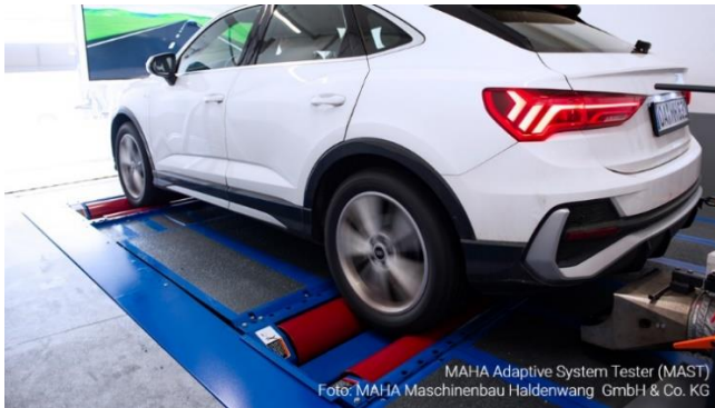
MAHA Adaptive System Tester (MAST) Foto: MAHA Maschinenbau Haldenwang GmbH & Co. KG
