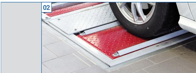
02 Der Achsdämpfungsprüfstand MSD 3000 zeichnet sich durch eine schnelle und präzise physikalische Überprüfung der Achsdämpfung aus (Lehr'sches Prinzip). Der vollautomatische Prüfablauf inkl. Ermittlung von Achs- und Fahrzeuggewicht ermöglicht dabei eine zeitsparende und sichere Beurteilung der Achsdämpfung.
