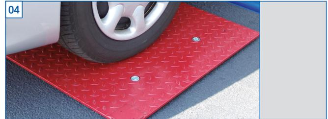
Der Achsspieltester LMS 20.0 dient zur zuverlässigen Ermittlung von Mängeln und Verschleiß an Lenkungsteilen, Radlagern, Federung und Aufhängung durch gegenläufige Quer- und Längsbewegung der Prüfplatten. Ein Automatikmodus sowie weitere unterschiedliche Betriebsmodi ermöglichen die unkomplizierte Bedienbarkeit des LMS 20.0
