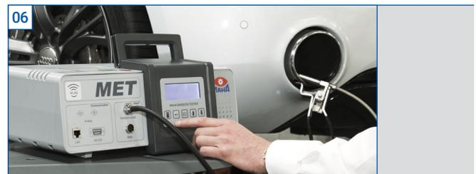
Unsere Abgasmessgeräte der MET 6 Serie dienen zur Messung von Benzin- und Dieselfahrzeugen. Daneben sorgen geringes Gewicht, kompaktes Design und kurze Aufwärmzeit für ein einfaches Handling.
