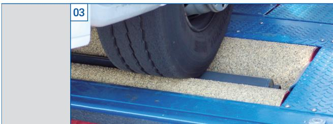
03 Der prüfstraßenfähige Rollen-Bremsprüfstand MBT 7000 dient zur Bremsprüfung von Fahrzeugen bis zu einer Achslast von 18,0 t und eignet sich ideal zur Diagnose bei sehr hohem Fahrzeugdurchsatz.
